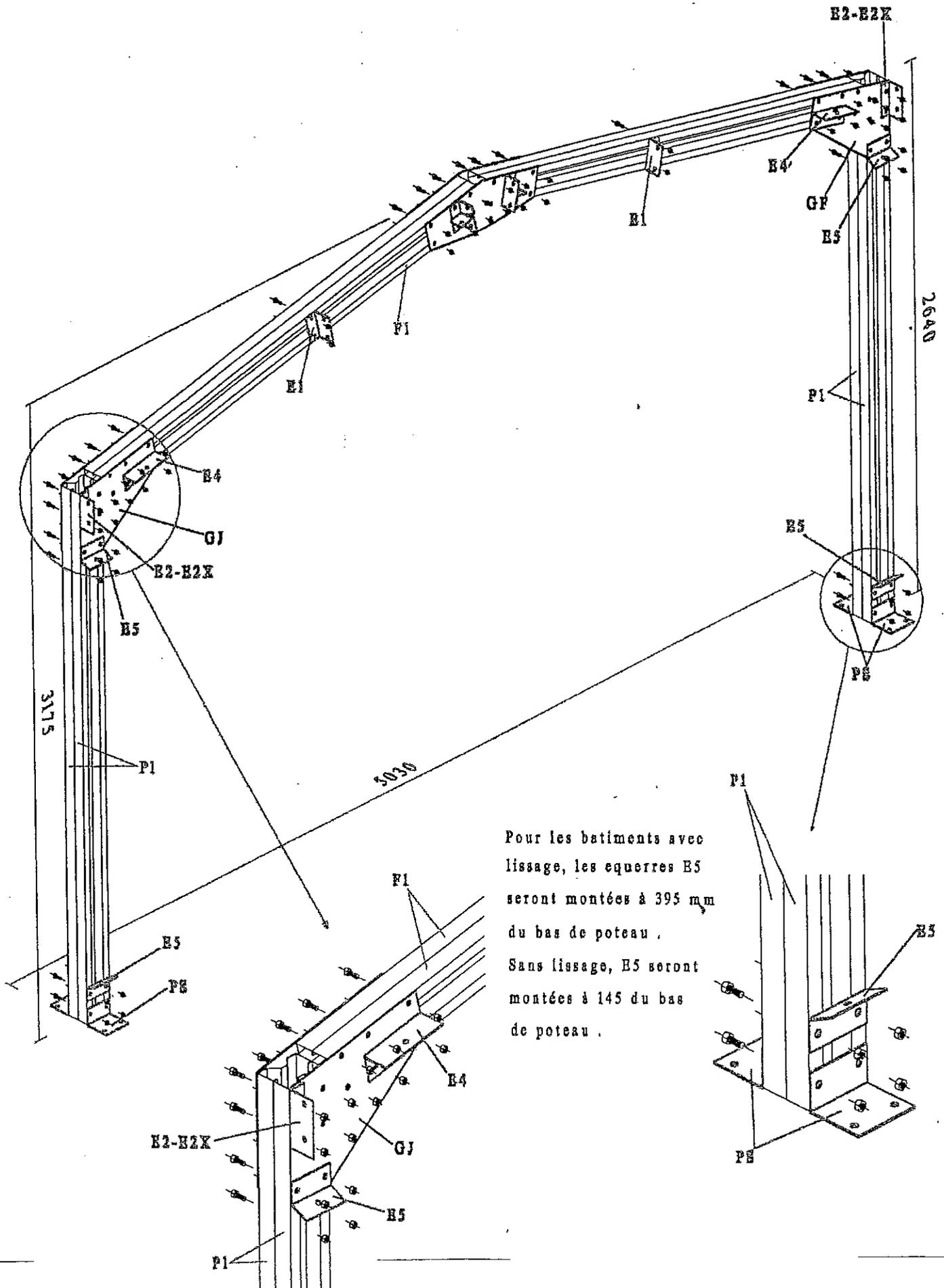
Pour les bâtiments avec lissage, les equerres E5 seront montées à 395 mm du bas de poteau .
